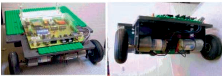
Προγραμματισμένο όχημα να κινείται σε ευθεία και να αποφεύγει τις συγκρούσεις
