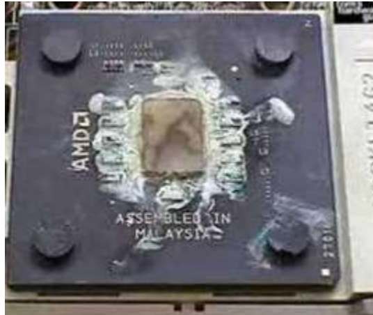
Εικόνα 2.1: Κατεστραμμένη Κ.Μ.Ε., λόγω υπερθέρμανσης
