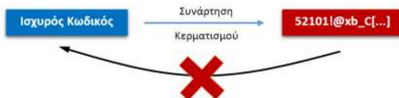
Εικόνα 8.7: Λειτουργία συνάρτησης κερματισμού
