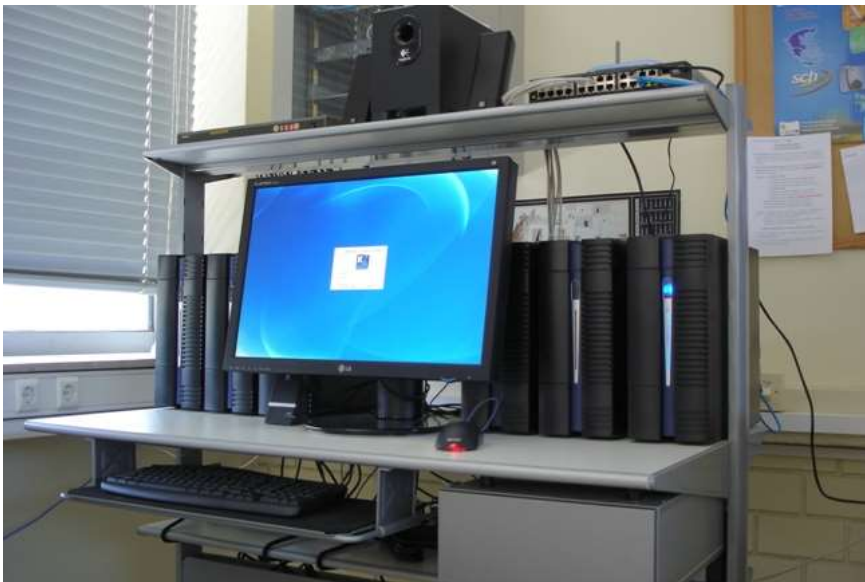
Εικόνα 4.2. Η συστοιχία υπολογιστών που έφτιαξαν οι μαθητές του 1 ου ΕΠΑΛ Αργυρούπολης αποτελείται από 6 υπολογιστές με διύρηνο επεξεργαστή και 2 GB RAM.
