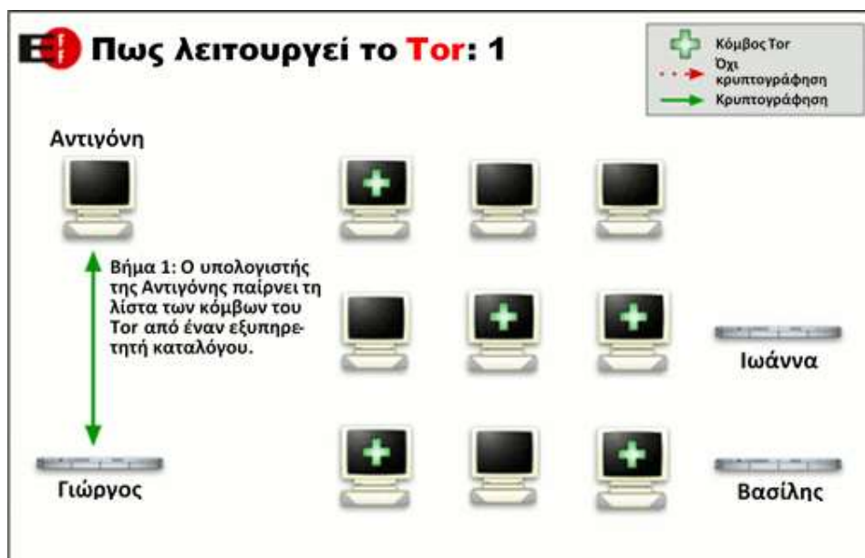
Εικόνα 8.20: Λειτουργία του Tor (βήμα 1).
