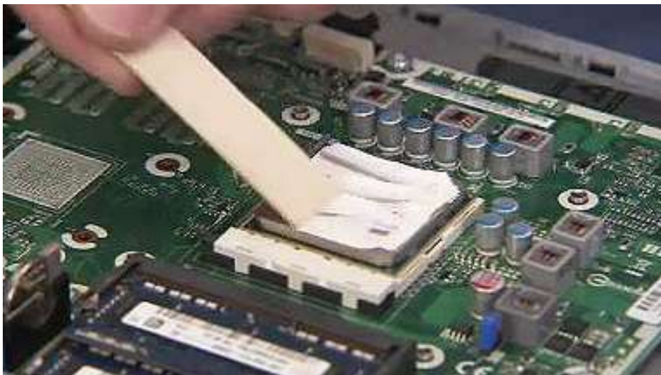
Εικόνα 2.7: Εφαρμογή θερμοαγωγίμης πάστας
