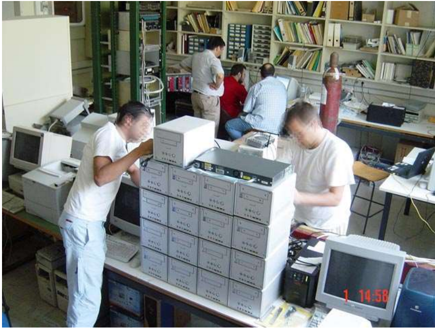
Εικόνα 4.1. Η συστοιχία 16 υδρόψυκτων υπολογιστών που κατασκευάστηκε στο Εργαστήριο Πειραματικής Φυσικής Υψηλών Ενεργειών της Σχολής Εφαρμοσμένων Μαθηματικών και Φυσικών Επιστημών του ΕΜΠ
