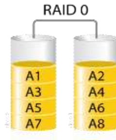
Εικόνα 3.1. Συστοιχία RAID 0 (striping).
