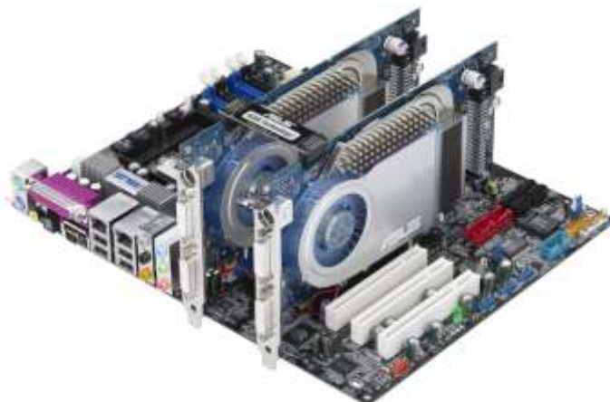
Εικόνα 1.3: Εγκατάσταση διπλών καρτών γραφικών τεχνολογίας SLI
