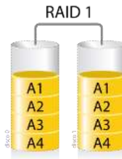
Εικόνα 3.2. Συστοιχία RAID 1 (mirroring).
