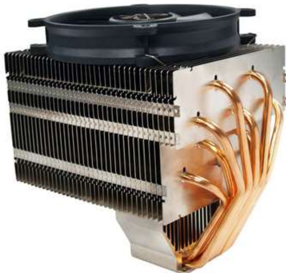
Εικόνα 2.9: Σύγχρονη ψύκτρα με θερμοαγωγούς
