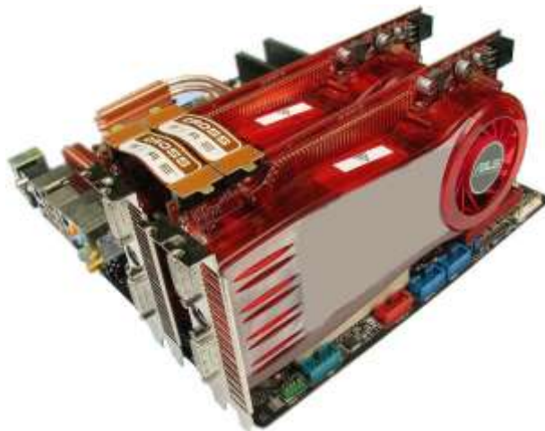
Εικόνα 1.2: Εγκατάσταση διπλών καρτών γραφικών τεχνολογίας Crossfire
